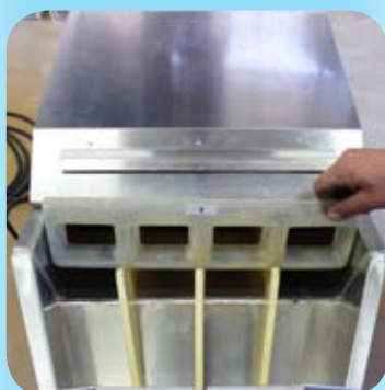
Contador pescavision 30 (tapa abierta) (Vista sobre separación de poliéster)
