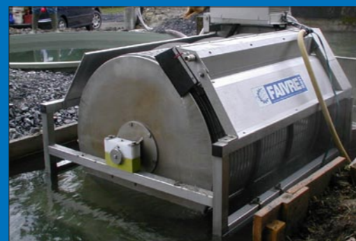
Modelo 9-120 en armazón (salida de piscicultura)
