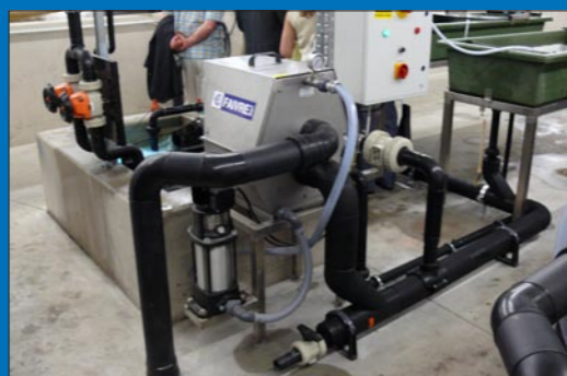
Modelo 2-40 con tela de 36µ para circuito cerrado.
