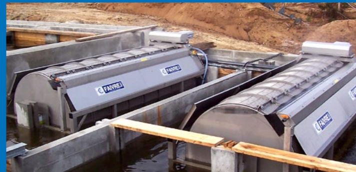
2 filtros 32-160 en armazón en una granja de esturión.
