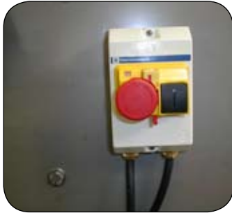
Boitier de commande IP 55 avec arrêt d'urgence
