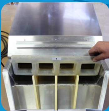
Compteur pescavision 30 capot ouvert (mise place d'un séparateur)
