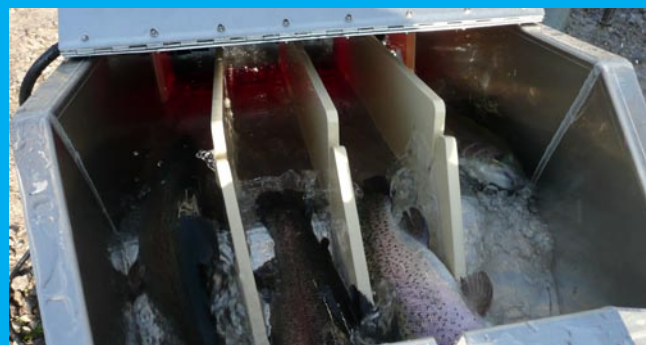
Vue capot ouvert d'un compteur PescaVision 30
