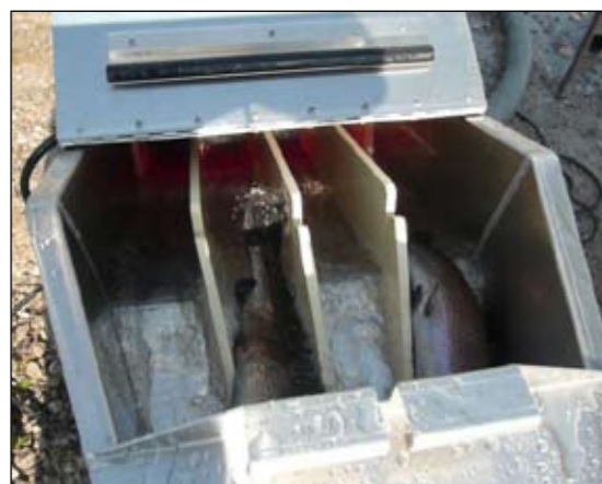
Intérieur d'un compteur Pesca Vision 30 avec 4 canaux de comptage.
