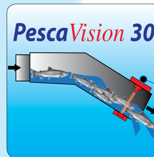
Schéma de principe du compteur Pesca Vision
