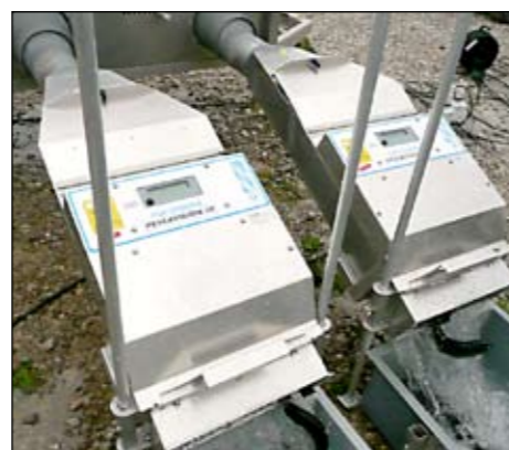
Compteur Pesca Vision 30 avec bac de réception dans une pisciculture couplé avec un trieu Hélios 50
