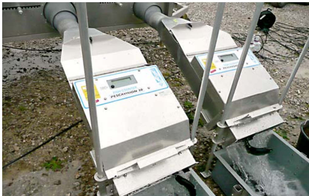
Pescavision 30 installés en sortie d'un trieur Helios 50
