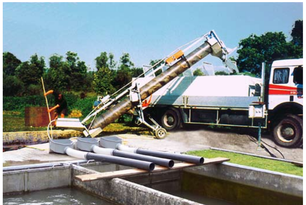
SÉRIE 85 Ø330 mm, longueur 5m avec portique pliable hydraulique
