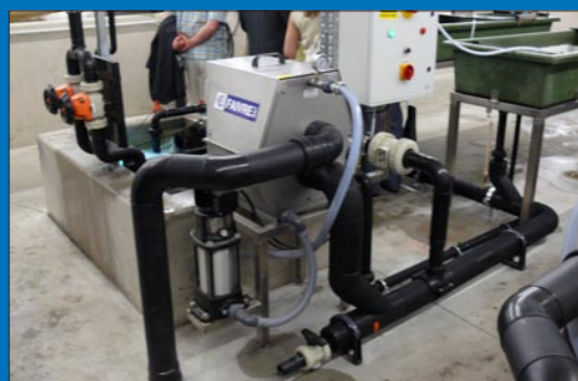
Modèle 2-40 avec maille de 36 microns dans un petit circuit fermé.
