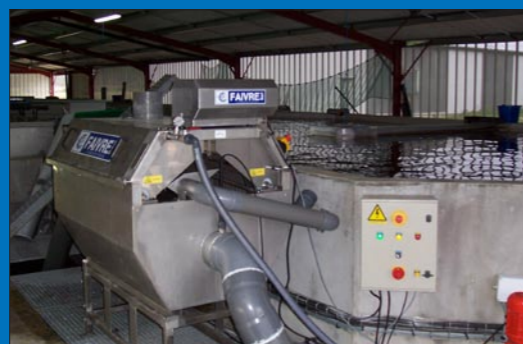
Modèle 4-80 avec maille de 60µ dans une crircuit fermé d'esturgeon
