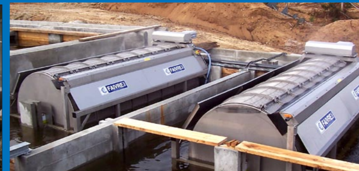
2 filtres 32-160 sur bâti dans une ferme d'esturgeon
