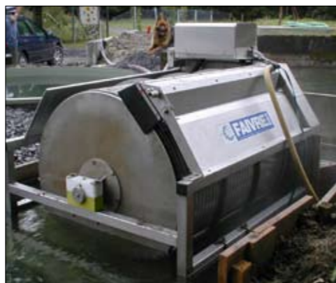
Filtration en sortie d'une pisciculture en Suisse; modèle 9-120 sur bâti
