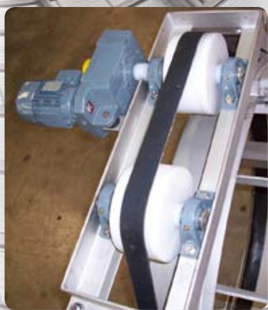
Entraînement et suspension du tambour par courroie poly V (Solution simple et robuste).
