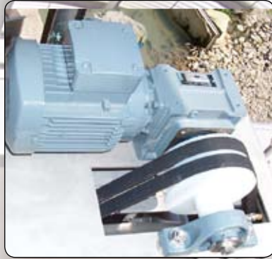
Entrainement du tambour par courroies, simple et fiable.
