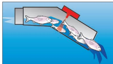
Le principe de ce compteur est simple, un rayonnement émis par les LED traverse chacun des canaux. Le poisson qui traverse le rayonnement donne une impulsion de comptage.
