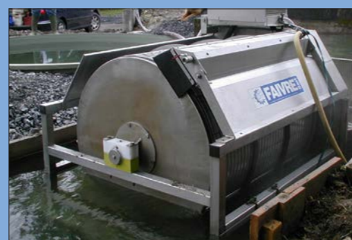
Modelo 9-120 en armazón (salida de piscicultura)
