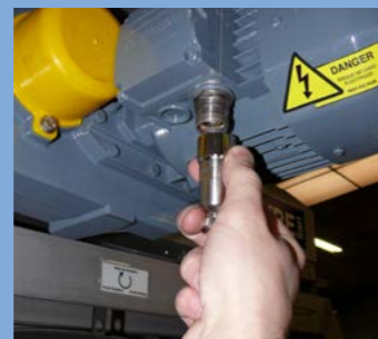
Modèle 4-80 avec maille de 60µ dans un circuit fermé d'esturgeon
