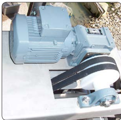
Entrainement et suspension du tambour par courroies (Solution simple et robuste)
