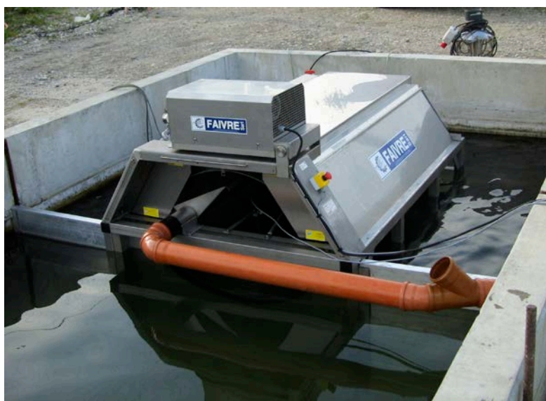
Filtre 9-120 à la sortie d'une pisciculture en suisse
