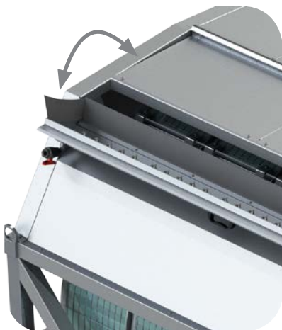
Rampe réversible ouverte pour un accès simple et rapide aux buses.
