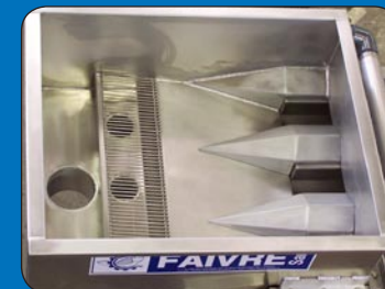
Вид изнутри бункера подачи рыбы с опцией подключения насоса для подачи рыбы и сепаратором воды.
