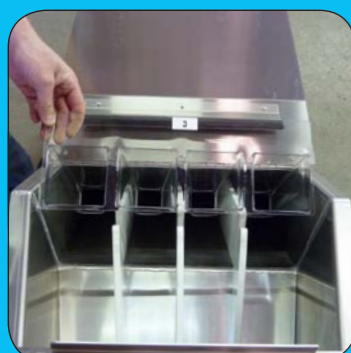
Contador pescaVision 30 tapa abierta (colocación de un separador)
