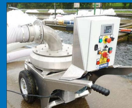
Construction avec des matériaux de qualité. Aluminium pour le châssis et inox 316L pour le corps de pompe.
