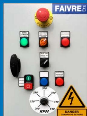
Armoire électrique équipée d'un variateur de vitesse.
