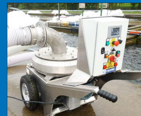
Полностью из алюминия и высококачественной нержавеющей стали AISI 316L.
